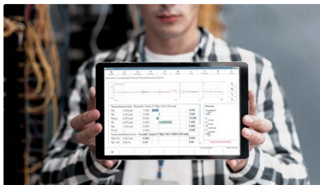
Vue de l'option RoughnessPlus : règles virtuelles pour la définition interactive des distances dans les directions X et Z dans le champ de profil
