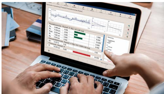
Vue Analyse : résultat avec profil, courbe de distribution d'amplitude (CDA), courbe Mr et surveillance des tolérances
